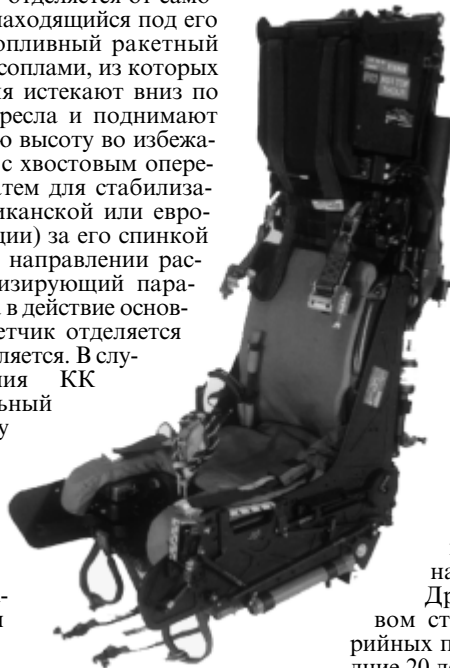
Рис. 2. Катапультное кресло NACES, используемое на самолетах ВМС США
