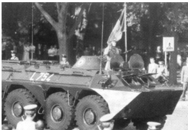
Рис. 2. БТР ТАВ-77 (8 x 8), состоящий на вооружении подразделений сухопутных войск
